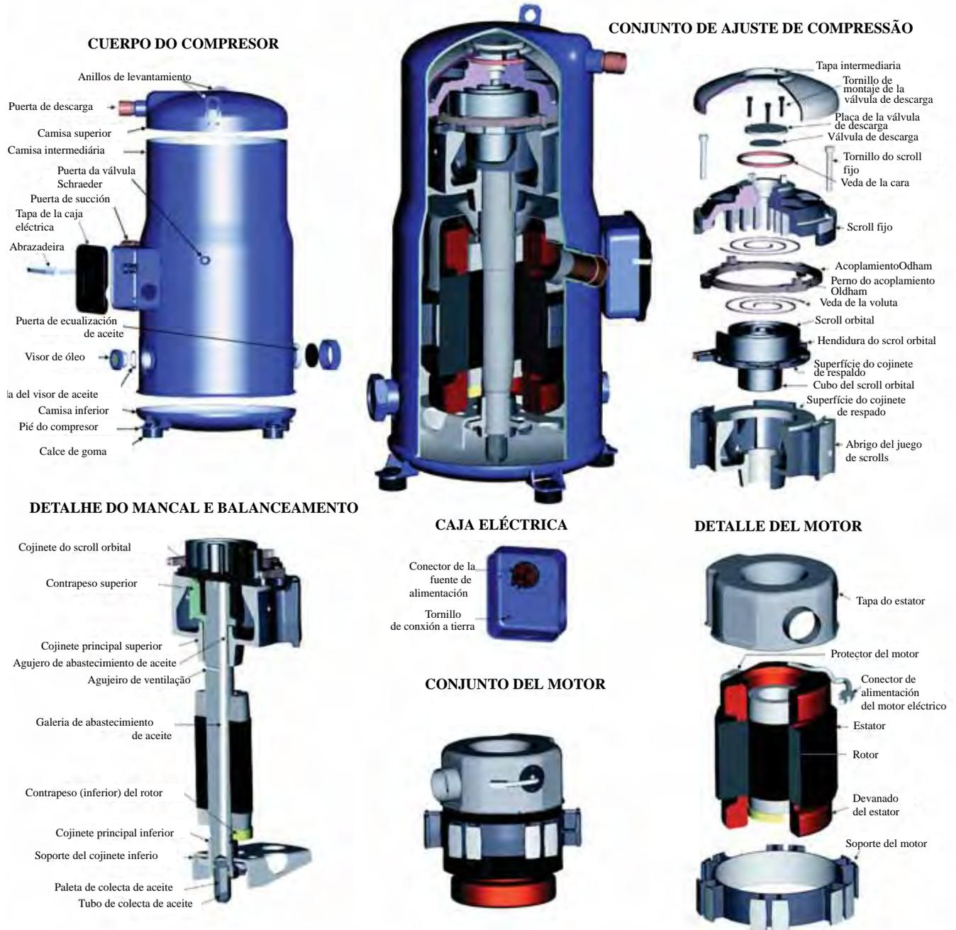
**Figura 10. Componentes internos del compresor en unidades de 15-30 TR**
