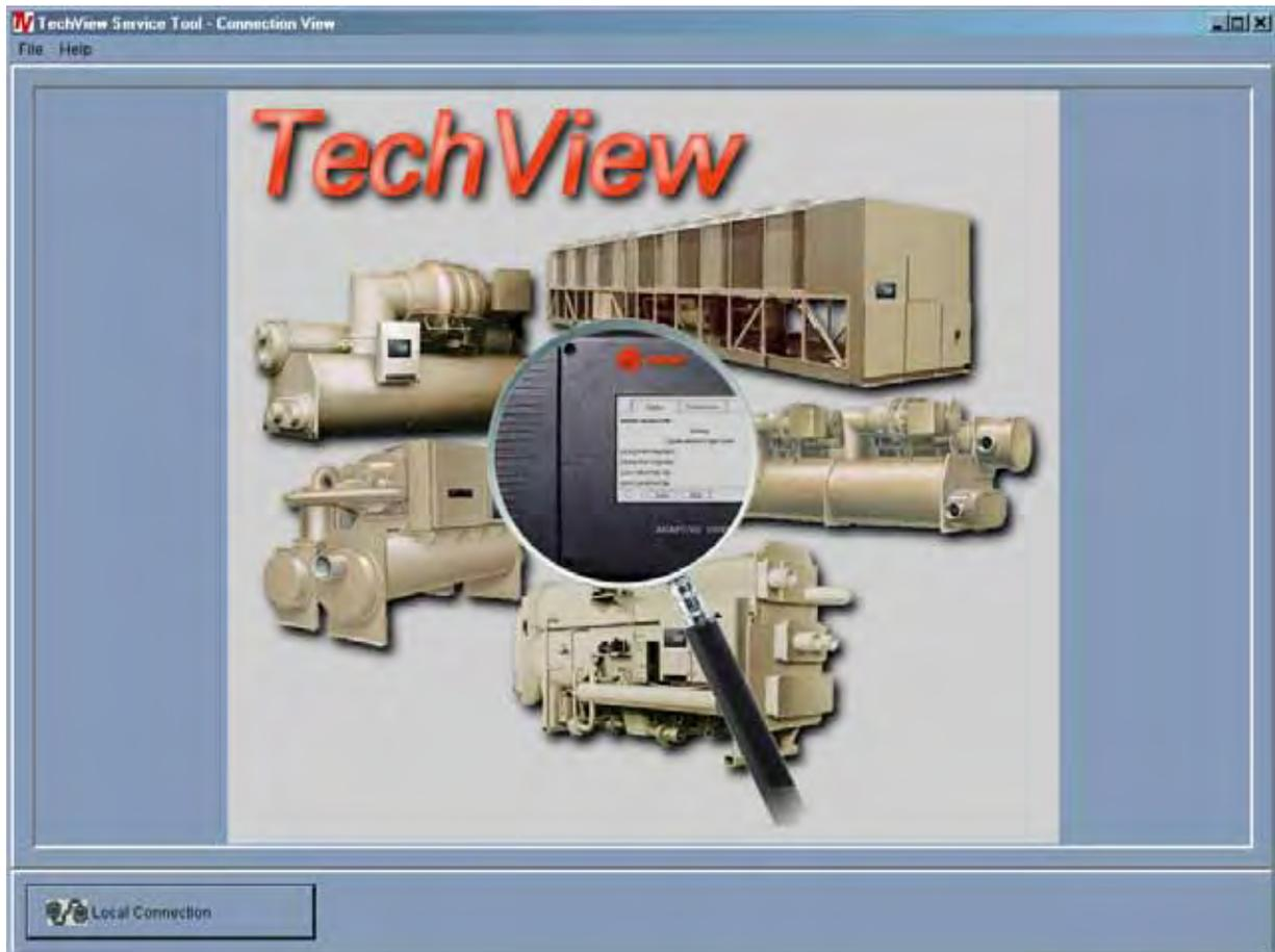
El TechView es la herramienta para PC (laptop) usada en la manutención del CH530 Tracer. Los técnicos que hacen cualquier modificación en el control del enfriador o atienden a cualquier diagnóstico con el CH530 Tracer deben usar un laptop que ejecute el software aplicativo "TechView". El TechView es un aplicativo de la Trane desarrollado para minimizar el tiempo de inactividad del enfriador y ayudar los técnicos a comprender la operación del enfriador y los requisitos de servicio.
